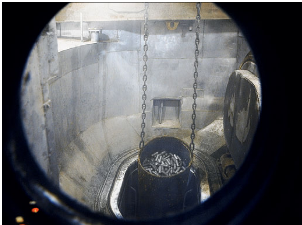
Шахта передачи облучённых урановых блоков с реакторного завода на радиохимический завод.
